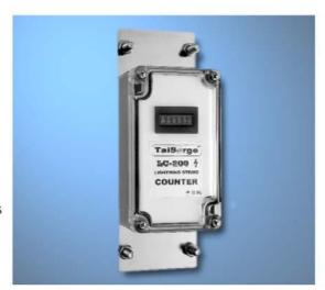
記錄針對落雷並記錄雷擊情形的次數,由於雷擊感應電壓的作用,經由電流感應偵測器,而刺激計數器產生計數動作,可作爲維修避雷裝置時的指標.
