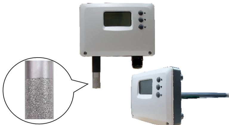
AHT-503H 系列溫溼度傳訊器採用高精度溫溼度感測元件，及微型電子電路設計。另外，感測探頭外殼為金屬燒結頭，透過金屬導熱性佳的特點，及特殊結構設計，可降低探頭高溼環境中的結露機率，避免損壞感測元件。穩定性高，應用於酒窖、香菇寮、花卉溫室、儲存室、釀造場所、植物工廠、家禽養殖場所、機房等。本傳訊器除了具有多種輸出信號外，亦可搭配 LCD 液晶顯示器，可做現場同步顯示之用。在安裝方式上，提供風管式、外氣式及分離式，可依現場環境狀況，選擇適用的款式。
